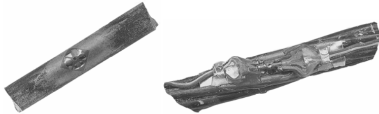
Slika 1 - Postavljanje rozete za određivanje stanja postojećeg stanja napona u armaturi i kablovima za prednaprezanje (2)
